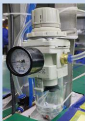
自动压装机气压表（可调节气压大小）
