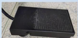
气动压装机的脚踏板（图3）
